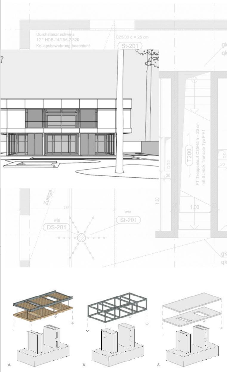
Das geplante unterkellerte Wohnhaus wird mit einem Obergeschoss in Holzbauweise errichtet.
